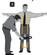
Если длина датчика (активная зона сканирования) металлоискателя меньше половины ширины тела досматриваемого (например, модель тактического металлоискателя ВМ-311), то алгоритм должен быть изменен в сторону увеличения проходов по вертикали со смещением, чтобы вся поверхность тела была в зоне сканирования.
